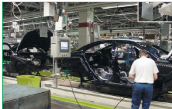
Blik op een werkpost met de Beckhoff HMI, de ingebouwde CX1000 en de Banner laserafstandsmeter (inzet, rechts boven) die de werkzone bepaalt.
