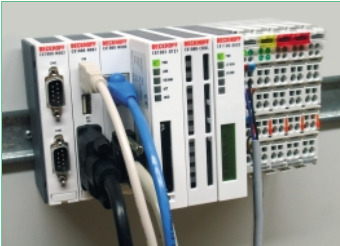
Een close-up van de CX1000 die instaat voor de visualisatie, communicatie en dataverwerking i.v.m. de schroefverbindingen.
